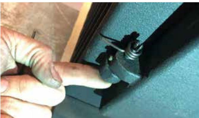
Le poêle est équipé d'une réglette qui se déplace de gauche à droite afin d'ajuster l'apport d'air qui alimente la combustion.
