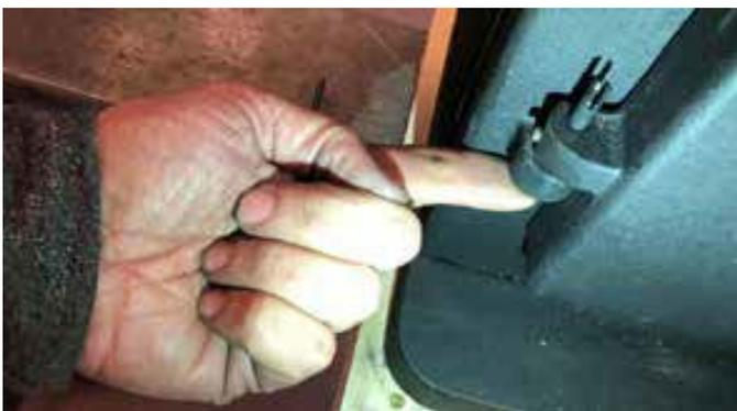
Placez le ressort sur le rivet. Mettez la vis et ajustez la tension du ressort, puis fixez-le en utilisant la vis de blocage.
