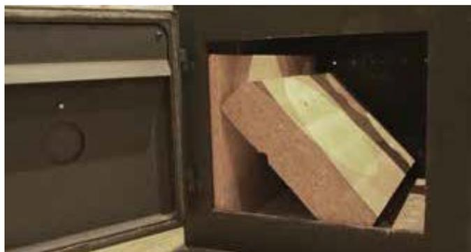
Déposez maintenant les déflecteurs sur la brique S2 : poussez d'abord S3 vers le fond, puis placez S4 sur le devant.
