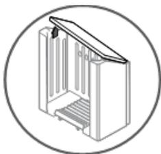
2. Soulevez un côté du déflecteur, puis l'ensemble dans cette position. Faites-le glisser légèrement sur le côté (gauche ou droite) pour le placer dans l'espace entre les panneaux latéraux.
