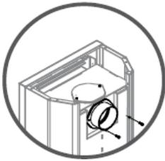
6. Placez la prise de sortie des fumées et le joint correspondant en partie arrière de l'appareil, de manière à ce que la soudure soit vers le haut, et fixez-la avec les vis.
