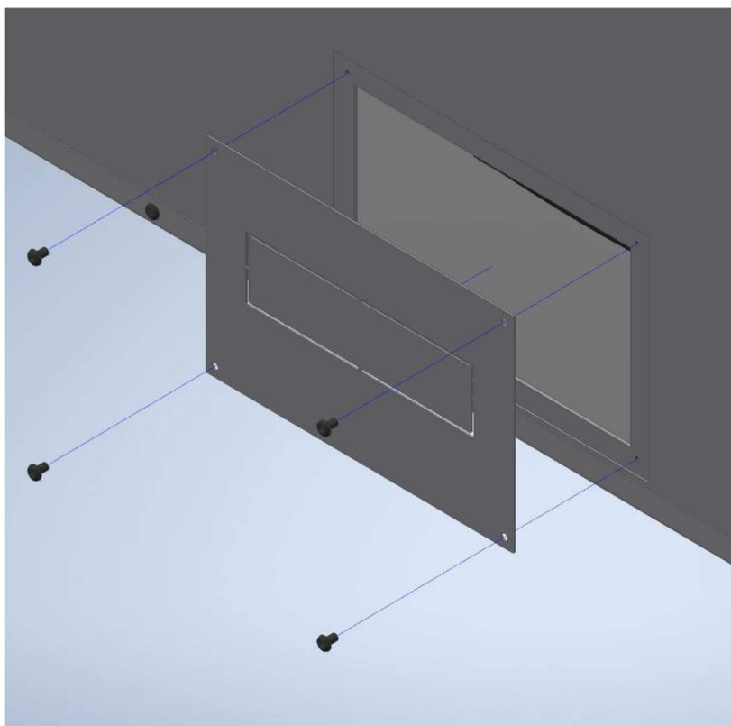
Placez le module d'arrivée d'air et serrez avec les vis
