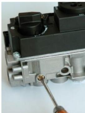
La hauteur minimale de la flamme du brûleur principal est réglée en usine par le fabricant.
