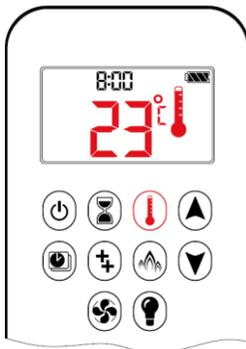
La température ambiante est mesurée et comparée à la température paramétrée. Ensuite, la hauteur des flammes est automatiquement adaptée pour atteindre la température paramétrée.
